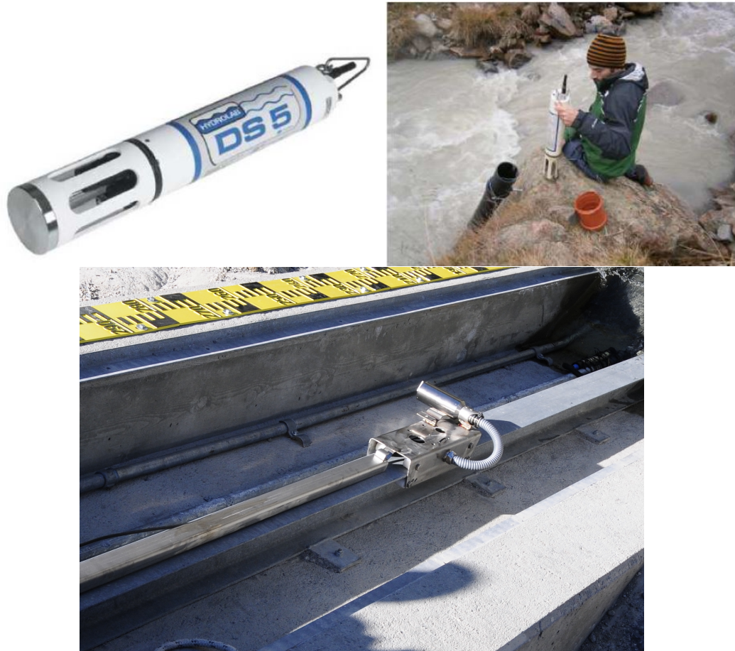
Figura 4.2: Monitoraggio continuo del trasporto solido in sospensione con l'utilizzo di un torbidimetro. Questo viene installato da un operatore e richiede una manutenzione più o meno frequente a seconda dell'intensità degli eventi di piena. Il torbidimetro può essere installato su un carrello mobile lungo una rotaia per facilitare le operazioni di manutenzione (sotto)
