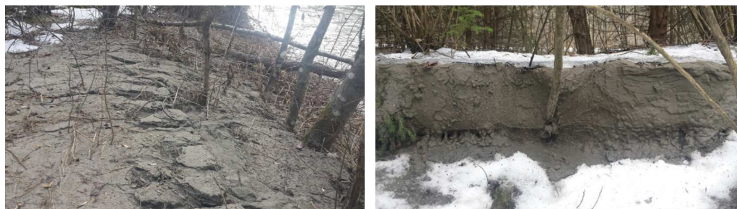
Figura 6.37: Depositi di materiale solido fine censiti lungo il corso della Rienza ca. 3 km a valle dello sbarramento di Kniepass nel marzo 2019
