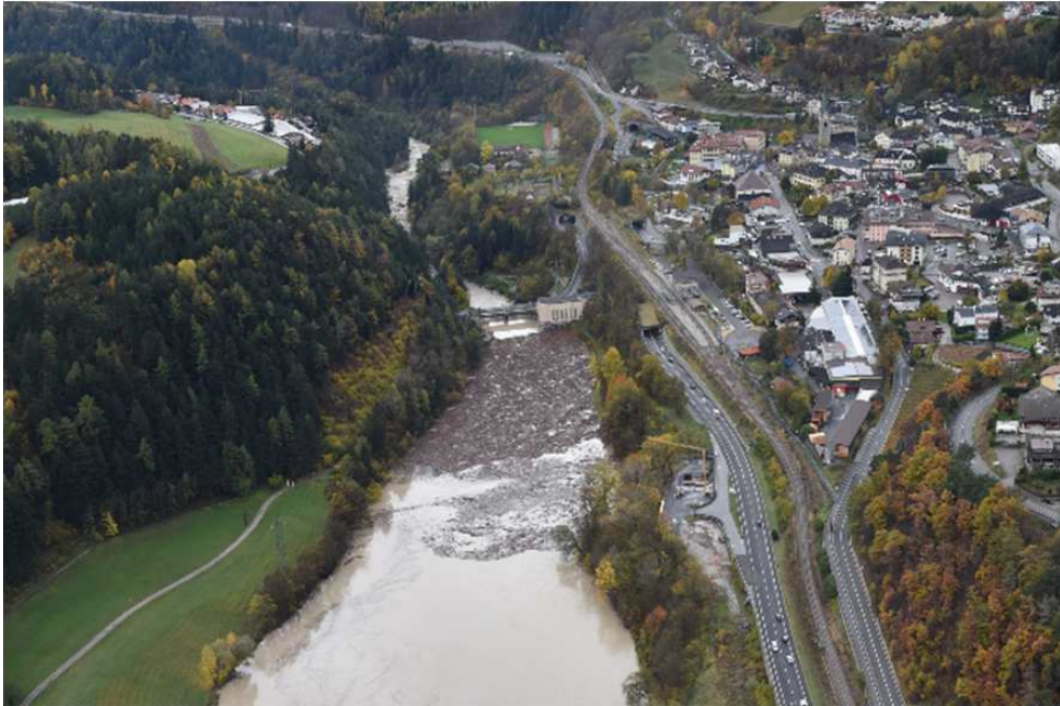
Figura 6.16: L'ingente deposito di materiale flottante presso lo sbarramento di Rio Pusteria (fonte: Agenzia per la Protezione Civile)
